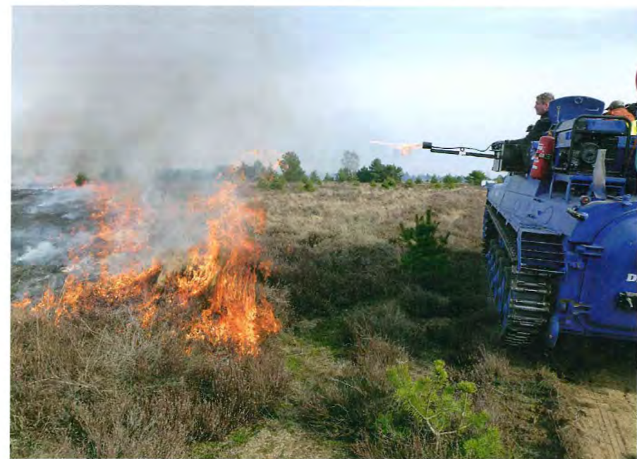
Abb. 6: Demonstration des Kontrollierten Brennens mittels gepanzerter Technik – hier Zündpanzer mit seitlich installierter Brennkanne – im Naturschutzgebiet „Marienfließ“, Brandenburg. (Foto: Frank Meyer)
